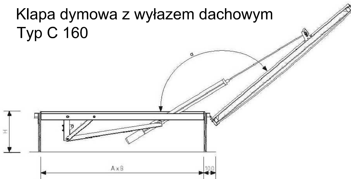
Rys. 19 – Przekrój B-B przez klapę oddymiającą
